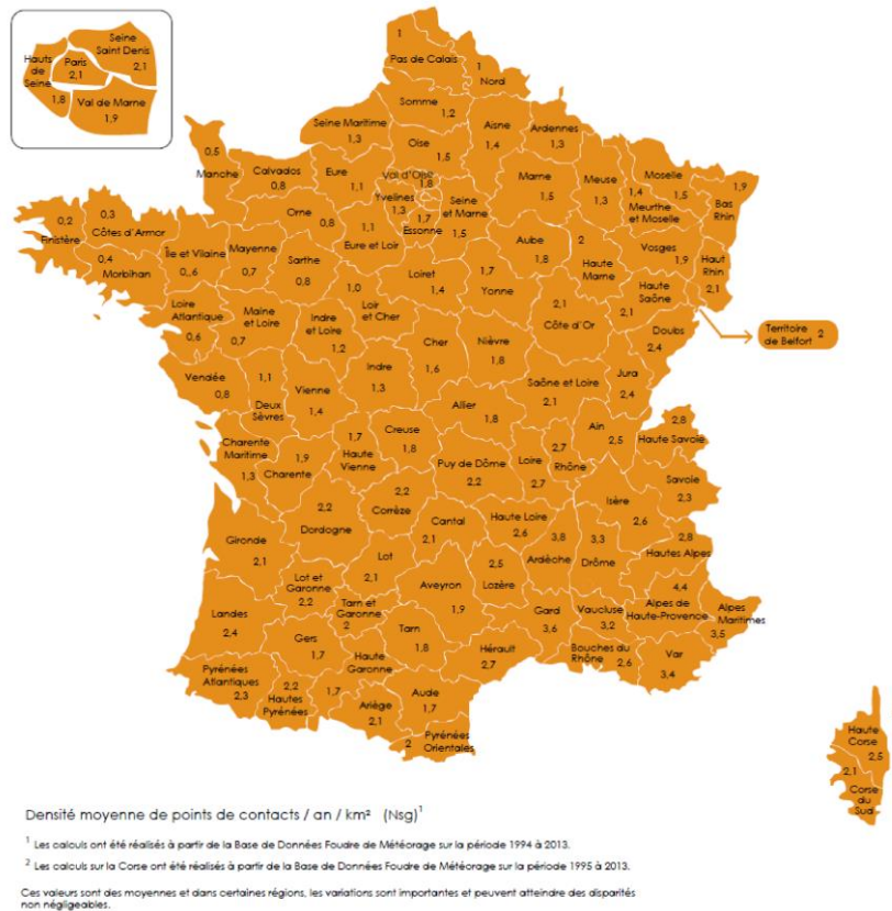
Figure 17 : Carte de la densité de foudroiement de la France issue de la norme NFC 17-102 (05-2015)
